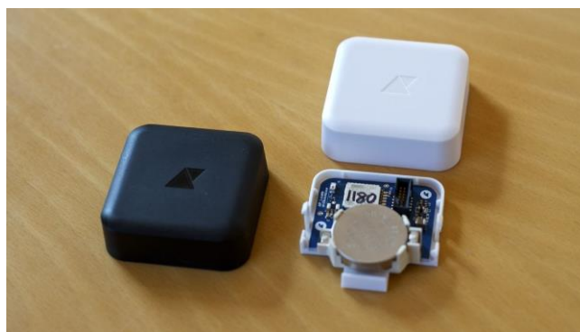
Figura 42 – Exemplo de sensor Beacon Fonte: RECKONER, 2014 22 .
